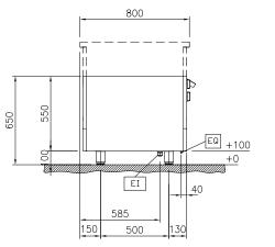
Electrical inlet (power) Equipotential screw EQ
